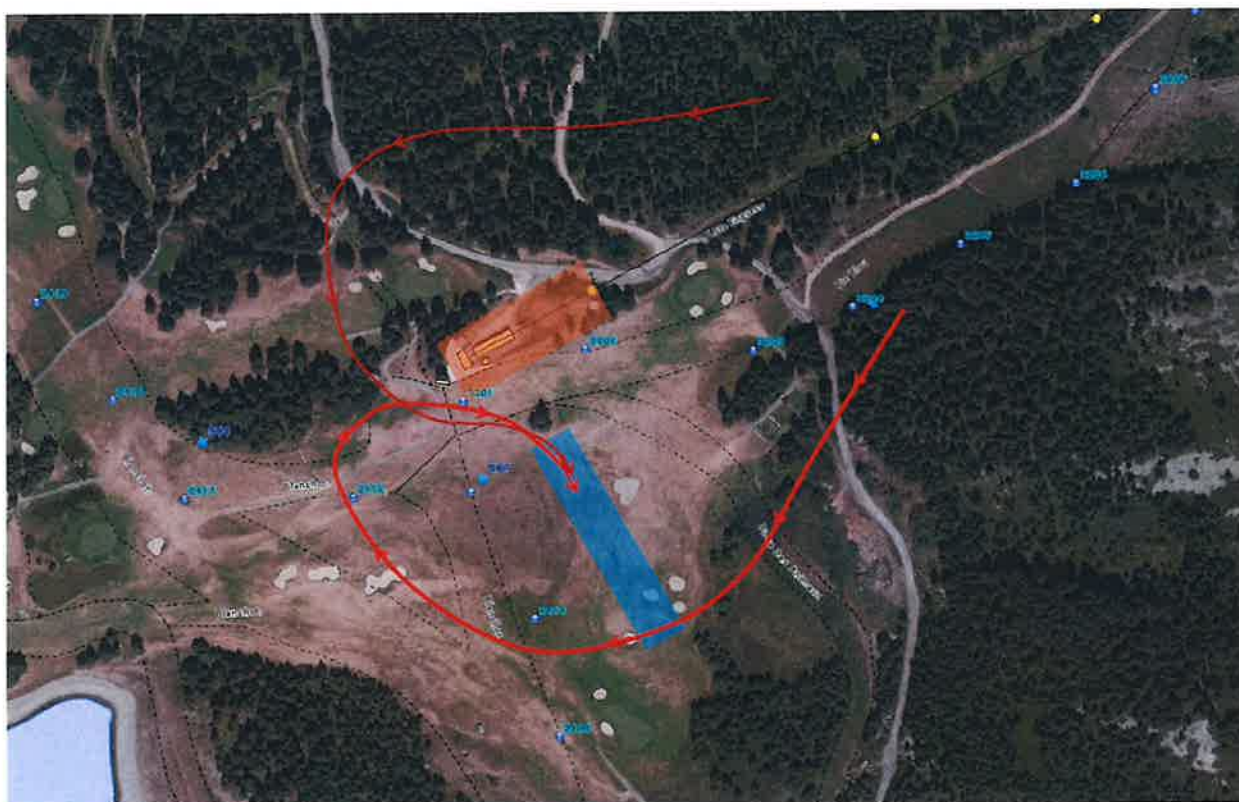
Zone d'atterrissage (Max : Longueur 130m x Largeur 20m) ➔ Plans de vol autorisés pour approche atterrissage Zone de survol interdite en approche atterrissage
